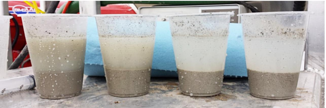
En la foto se observa como los detritos se van depositando en el fondo del recipiente, este debería tomar entre 15 y 20 segundos.
